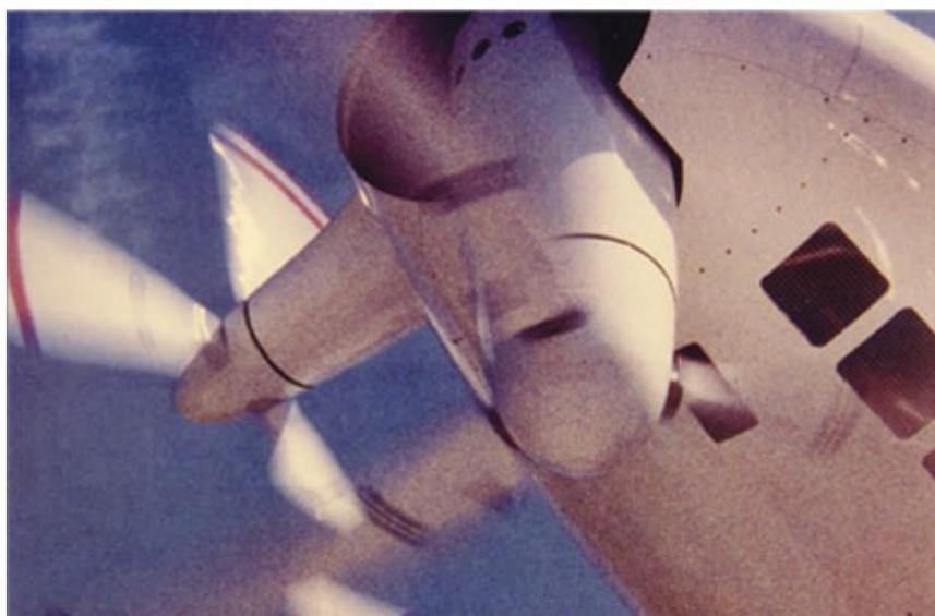
Los nuevos motores orientables de un moderno dirigible Zeppelin NT facilitan enormemente las maniobras de despegue y aterrizaje. Fuente: Zeppelin Luftschifftechnik.
