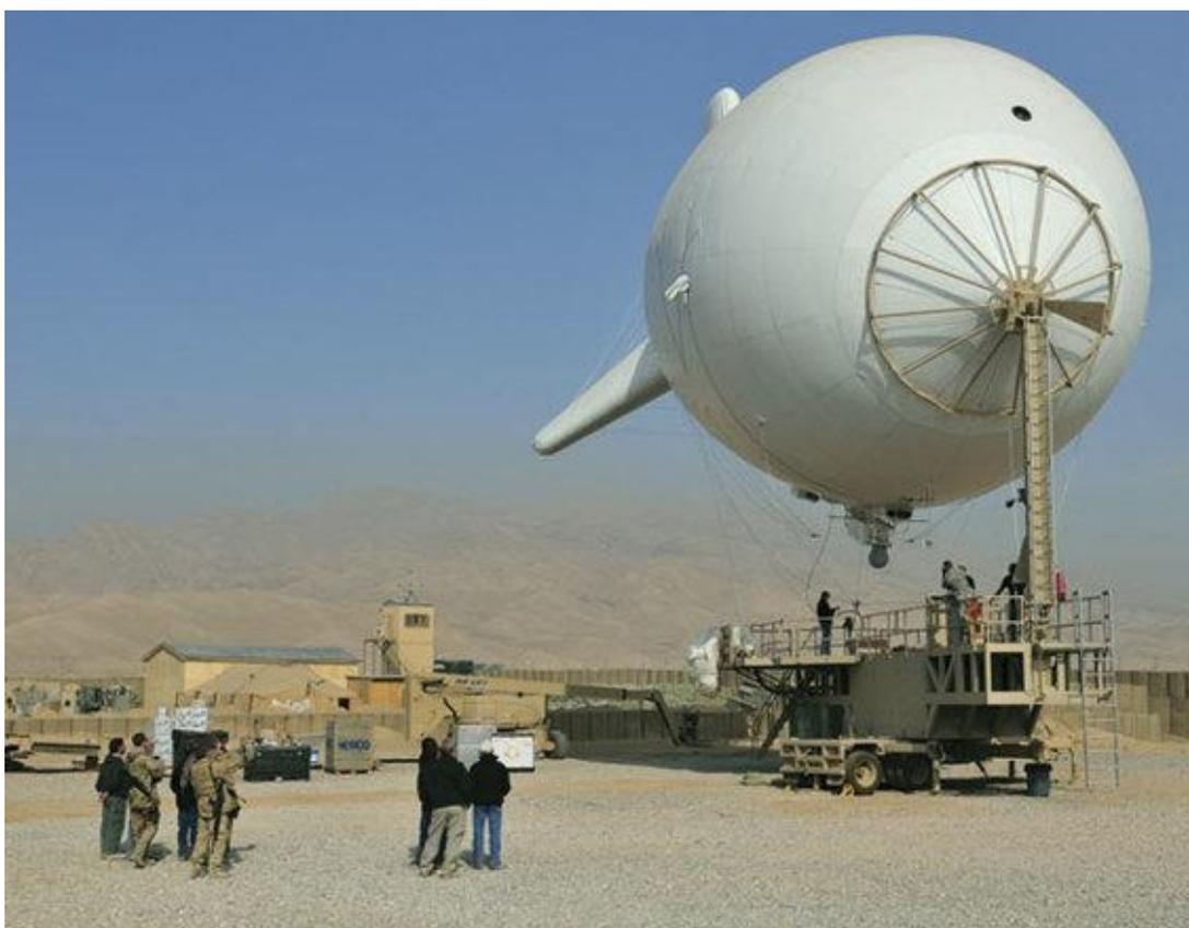
En esta imagen de un dirigible de reconocimiento del US Army tomada en la base de Khilegay, se aprecia en la parte inferior el radomo que contiene la cámara de observación. Fuente: US Department of Defence.
